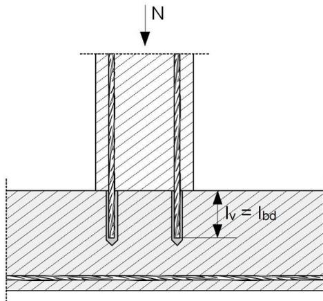
**Bild 4:** Bewehrungsanschlüsse überwiegend auf Druck beanspruchter Bauteile
