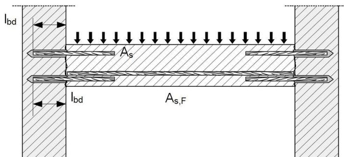
**Bild 3:** Endverankerung von Platten oder Balken
